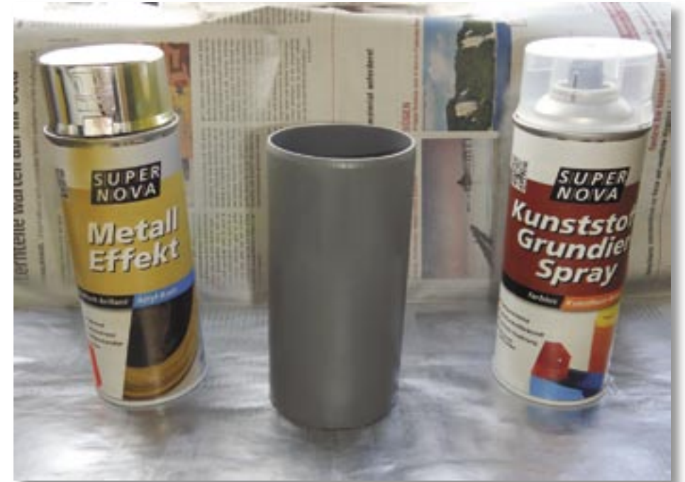
Wünscht man ein ansprechenderes Aussehen, kann man das Haltungsrohr mit Spray entsprechend einfärben. Eine Grundierung sollte man dabei nicht vergessen.
